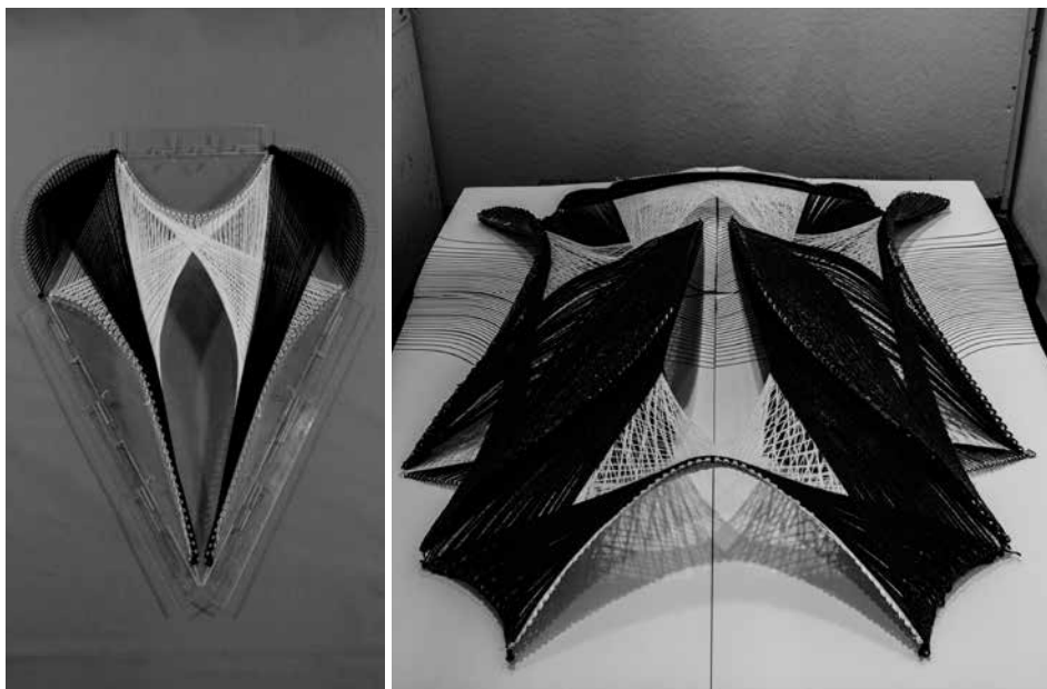
> 左：哈佛大学研究生汪隽和赖尊恒对两种不同纤维交叉编织的尝试。扇形有机玻璃骨架下方可旋转的轴，使得建筑的边界在编织过程中可以调整自身位置。
